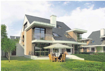
Buildunki zostaną posadowione na fundamentach żelbetonowych. Ściany zewnętrzne powstaną z bloczków silikatowych
